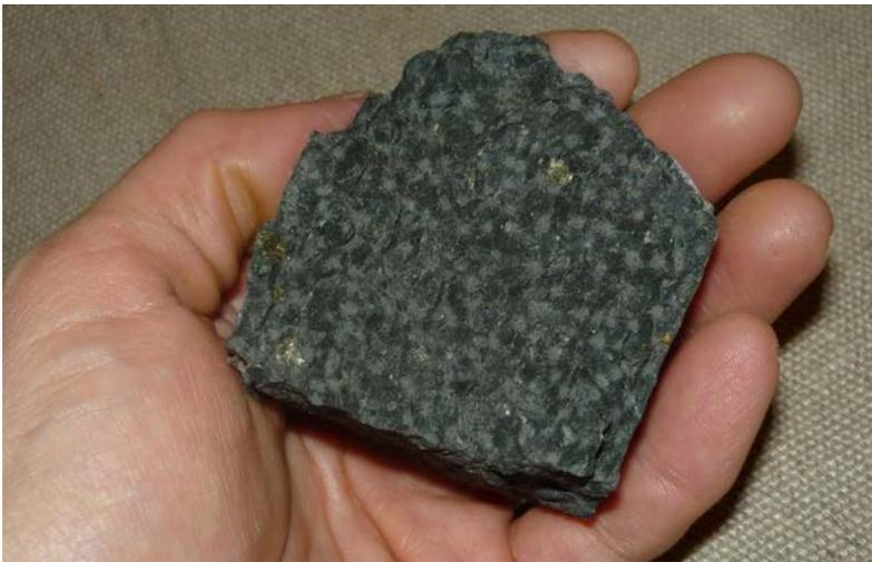
**Abb. 14:** „Sonnenbrenner“ im Basanit – weiße Flecken zeigen den Beginn des Zerfalls
